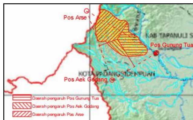
Gambar 3. Luas Daerah Pengaruh Tiap Pos Pada DAS Melalui Poligon Thiessen
