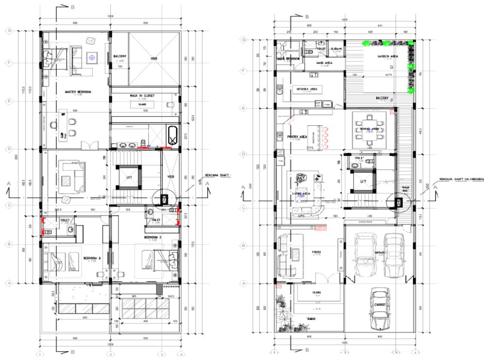
Gambar 3. Denah lantai 1 dan lantai 2 bangunan
