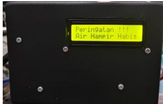
Gambar 8. Tampilan alat pada saat pompa air dalam keadaan tidak aktif dan air dalam tangki kosong
