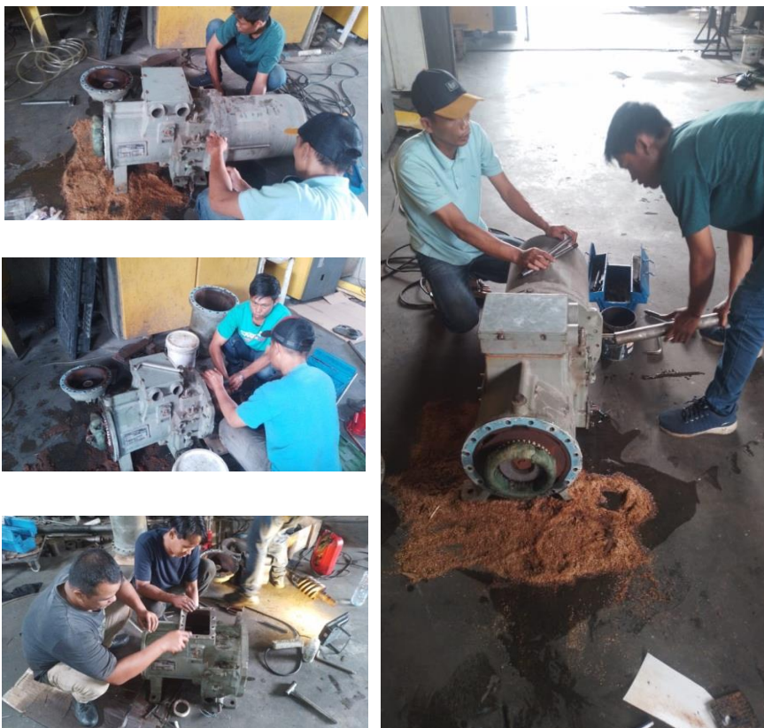
Gambar 3. Para Teknisi Melakukan Perbaikan Kompresor Chiller
